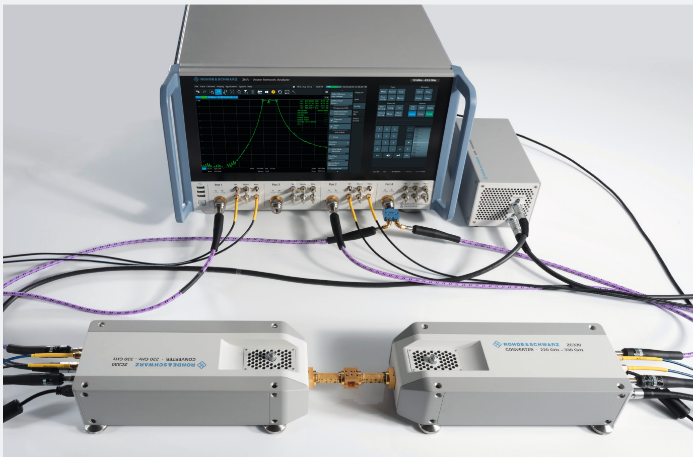
Установка для измерений в миллиметровом диапазоне, состоящая из анализатора R&S®ZNA43 и двух преобразователей миллиметрового диапазона WM-864 R&S®ZC330
