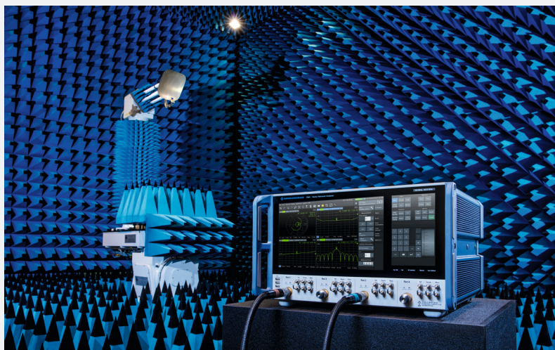
Анализатор цепей R&S®ZNA образует мощное ядро в системах тестирования антенн.
